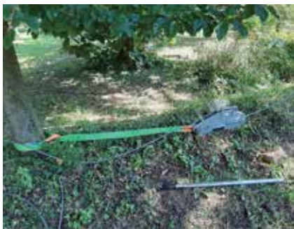
Ryc. 3.17. Wciągarka przymocowana do punktu kotwienia za pomocą szerokiego pasa
