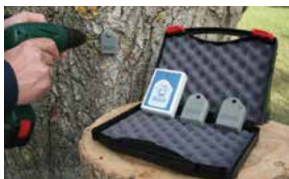
Ryc. 3.41. Tanie czujniki o niższej rozdzielczości zapewniające łatwą obsługę i długoterminowe monitorowanie wychylenia drzew (zdjęcie dzięki uprzejmości Argus Electronic GmbH)
