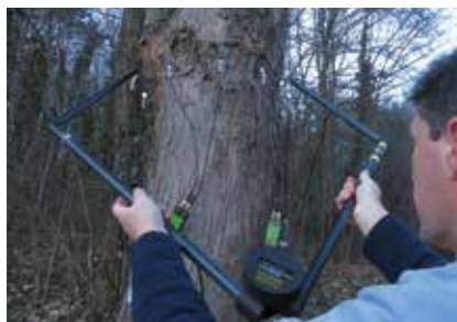
Ryc. 2.19. Użycie średnicomierza elektronicznego
