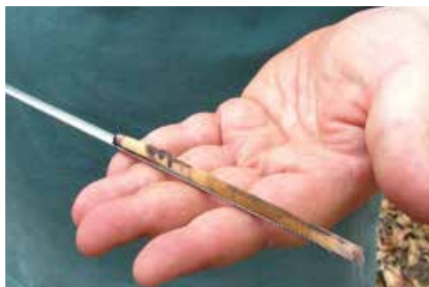
Ryc. 2.2. Próbka (zdrowego) drewna widoczna w tulei świda
