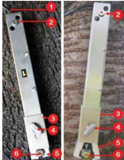
Ryc. 311. Czujnik odkształcenia w pozycji zamkniętej (po lewej) i otwartej (po prawej). (1 – linka, 2 – obudowa, 3,4,5 – mechanizm blokujący, 6 – ruchomy rdzeń. Zdjęcie dzięki uprzejmości FAKOPP Ltd.)
