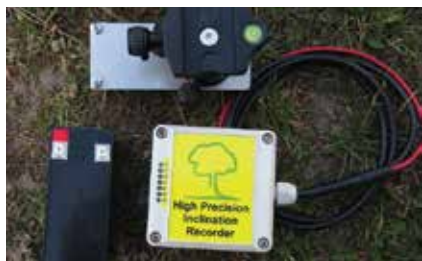
Ryc. 3.40. Bardzo precyzyjny inklinometr z płytką montażową i źródłem zasilania
