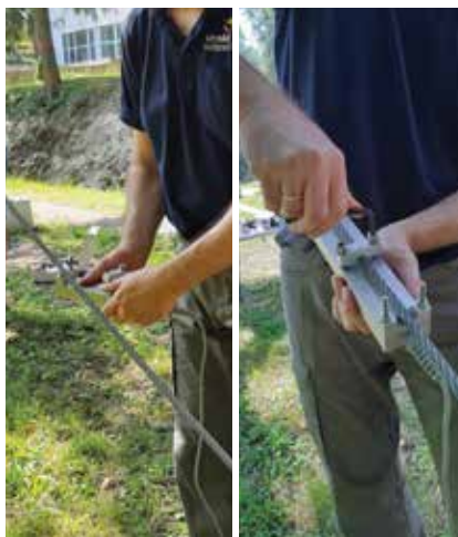
Ryc. 3.18. Mocowanie przyrządu do pomiaru obciążenia na linie
