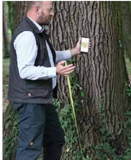
Ryc. 2.25. Dąb. Zakończony pomiar. Tomogram pokazany na ekranie smartfonu
