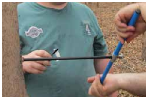
Ryc. 2.1. Pobieranie próbki za pomocą świda przyrostowego
