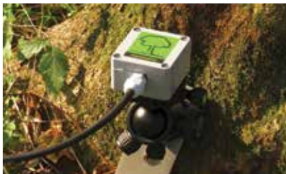
Ryc. 3.8. Inklinometry montowane na szyi korzeniowej (zdjęcia dzięki uprzejmości Argus Electronic GmbH i FAKOPP Ltd.)
