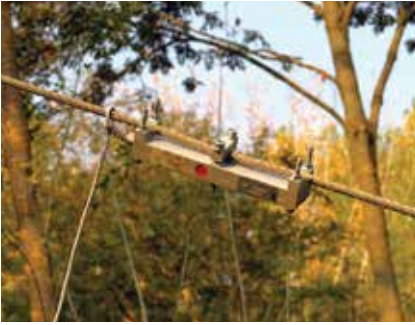
Ryc. 3.6. Przyrząd do pomiaru obciążenia montowany na linie
