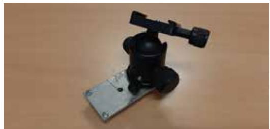
Ryc. 3.9. Płytki montażowe do mocowania inklinometru z dwuosiową poziomnicą
