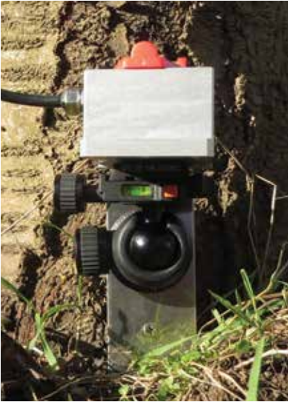
Ryc. 3.22. Płytkę montażową z wbudowaną poziomnicą
