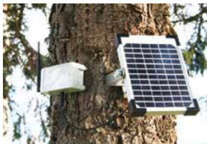
Ryc. 3.39. Czujnik inklinacji wyposażony w zasilanie słoneczne z możliwością zdalnego monitorowania umożliwia kilkumiesięczną pracę bez nadzoru (zdjęcie dzięki uprzejmości Argus Electronic GmbH)
