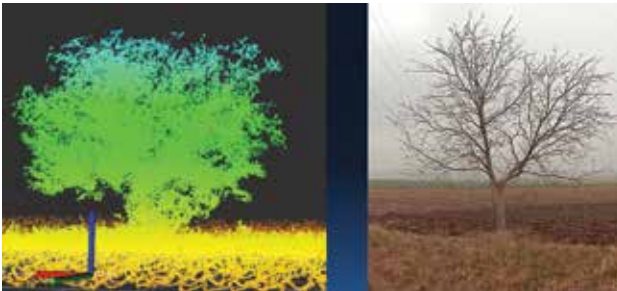
Ryc. 5.3. Chmura punktów w obrazie drzewa z LiDAR (po lewej) i fotografia tego drzewa (po prawej)
