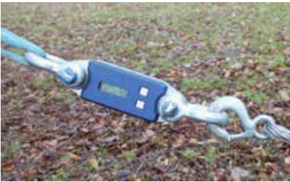
Ryc. 3.7. Przyrząd do pomiaru obciążenia montowany pomiędzy pasem a liną (zdjęcie dzięki uprzejmości Argus Electronic GmbH)
