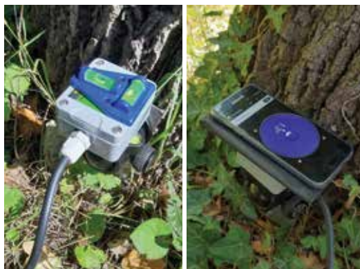
Ryc. 3.21. Poziomowanie inklinometru za pomocą małej poziomicy (na górze) lub aplikacji na telefon komórkowy (na dole)
