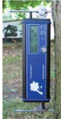
Ryc. 310 Czujnik odkształcenia montowany na pniu (zdjęcie dzięki uprzejmości Argus Electronic GmbH)
