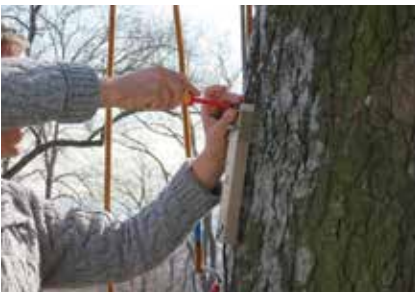
Ryc. 3.24. Montowanie elastometru na pniu drzewa (urządzenie zablokowane)
