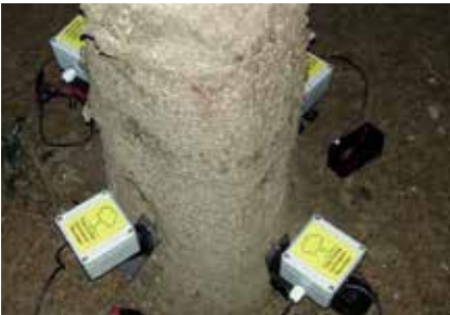
Ryc. 3.23. Zastosowanie kilku inklinometrów na tym samym drzewie
